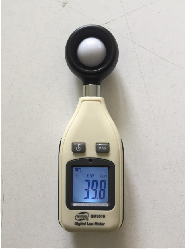
Şekil 4.33: BENETECH Marka GM1010 Dijital Işık Ölçer (Lux Meter)
