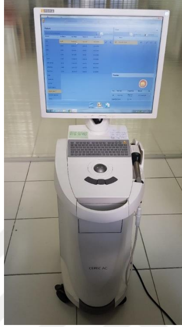
Şekil 2.13. CAD/CAM tarama ve tasarım cihazı (CEREC).
