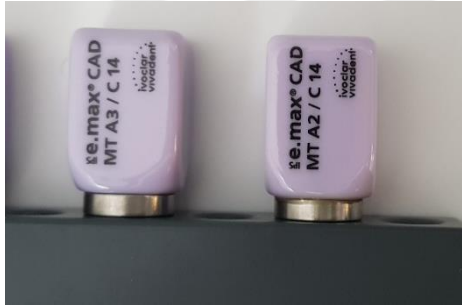
Şekil 2.11. Cam seramik materyal (IPS e-max CAD).
