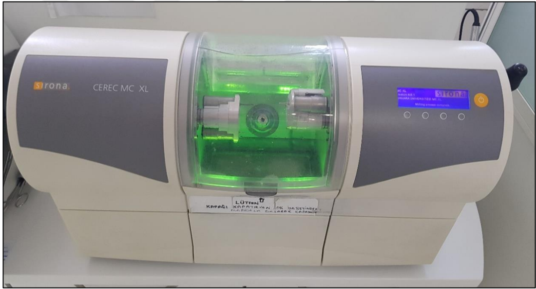
Şekil 2.17. Dijital üretim cihazı (CEREC MC XL).
