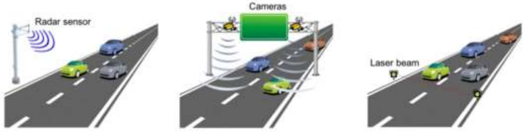
Şekil 3.10. Yolu uzaktan gören algılayıcı sistemler (Ibanez vd., 2018)
