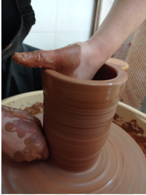
Resim 1: Çamur Tornasında Bir Eli İçten Diğer Elin Dışarıdan Baskı Uygulayarak Şekillendirilen Çamur
