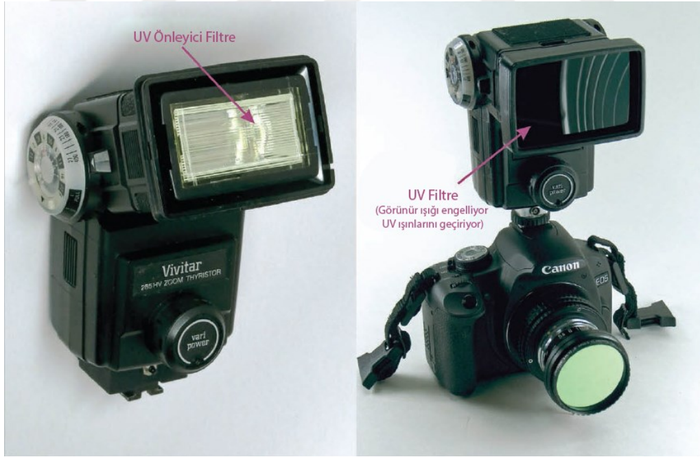
Şekil 13: Flaşın UV Filtre Takılarak Modifiye Edilmesi
