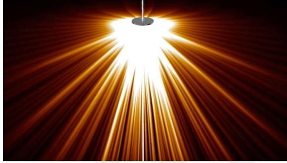
Şekil 2.7. Tungsten hedefe çarpan X-ışını dağılımı (Elekta Oncology Systems)
