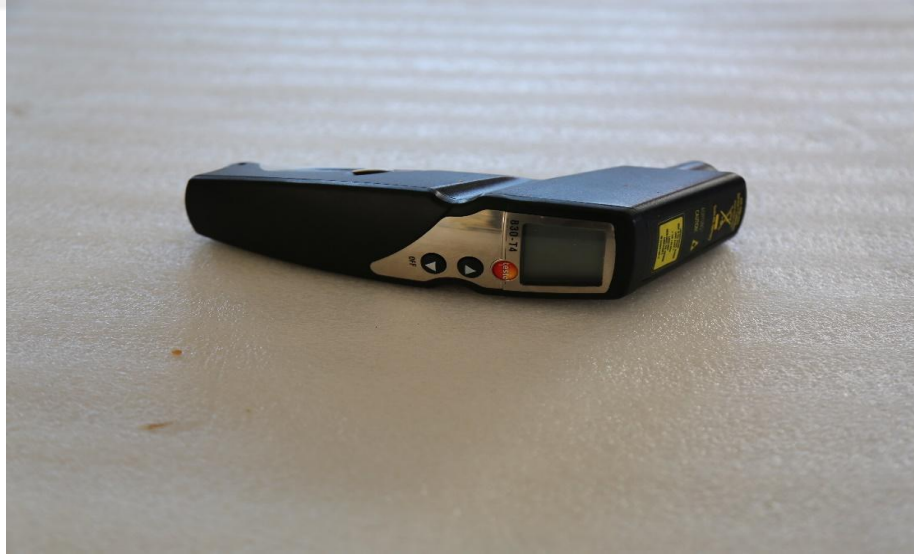
Şekil 25. Kompresör üstü sıcaklığının ölçüldüğü lazerli sıcaklık ölçme cihazı.
