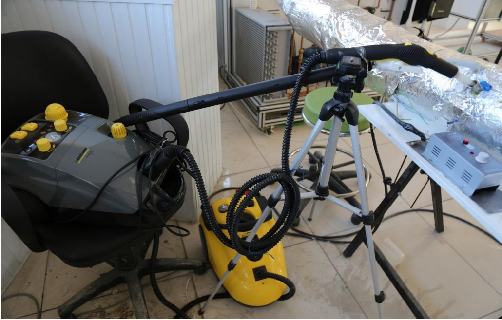
Şekil 27. Hava kanalına su buharı üreten buhar makineleri.
