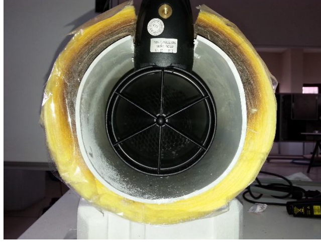
Şekil 21. Hava hızını ölçen anemometre.
