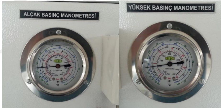
Şekil 16. Alçak ve Yüksek Basıncı Gösteren Manometreler.
