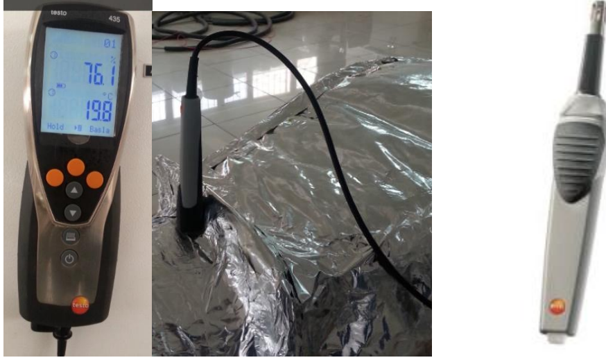
Şekil 17. Hassas sıcaklık ve bağıl nem ölçme ve kayıt cihazları.
