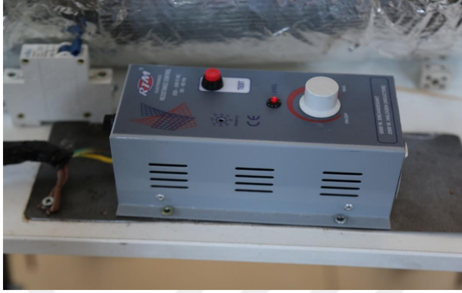
Şekil 26. Havanın sıcaklığının artırılması için rezistanslara gerekli elektriği enerjisini ayarlamaya yarayan dimmer.
