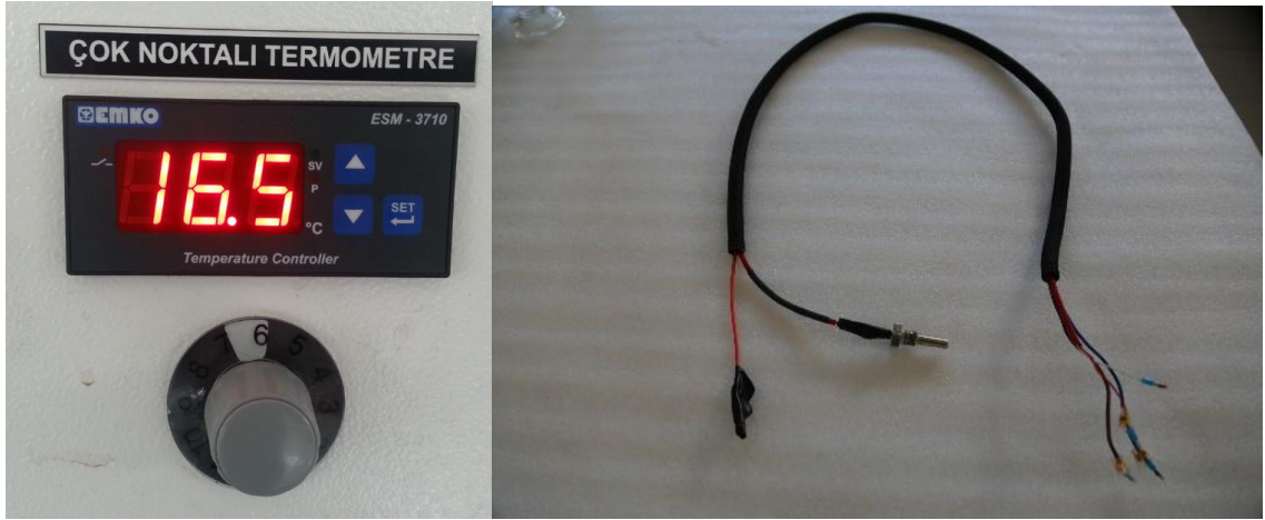
Şekil 15. Sıcaklık ölçüm göstergesi ve kullanılan termokupl.
