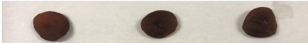
Şekil 4.5. Çözelti miktarını hesaplamak için yapılan ön denemeler sonucunda elde edilen ürünler (Sırasıyla % 25 nemli organik kuru kayısı, % 30 nemli organik kuru kayısı ve % 35 nemli organik kuru kayısı)
