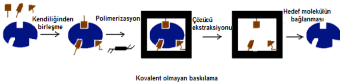
Şekil 2.16. Kovalent olmayan baskılama yönteminin gösterimi
