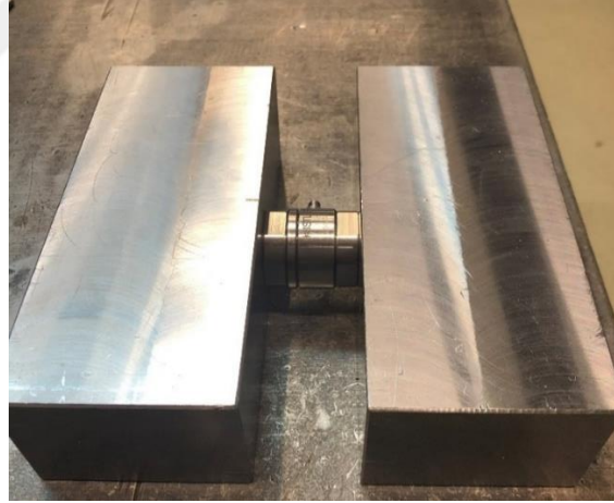
Şekil 3.7. Kuvvet sensörünün iş parçasına bağlanma şekli
