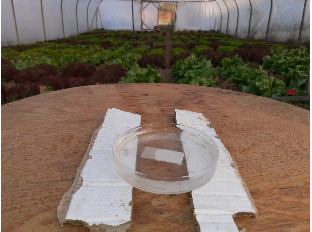
Şekil 3.6. Buharlaşma miktarının belirlenmesinde kullanılan cam petri kabı
