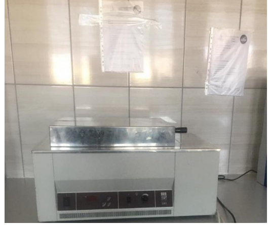
Şekil 3. 3. Çalkalamalı su banyosu
