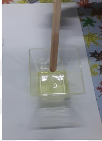
Şekil 5.34 : yapıştırıcı ile sertleştiricinin karıştırılması.
