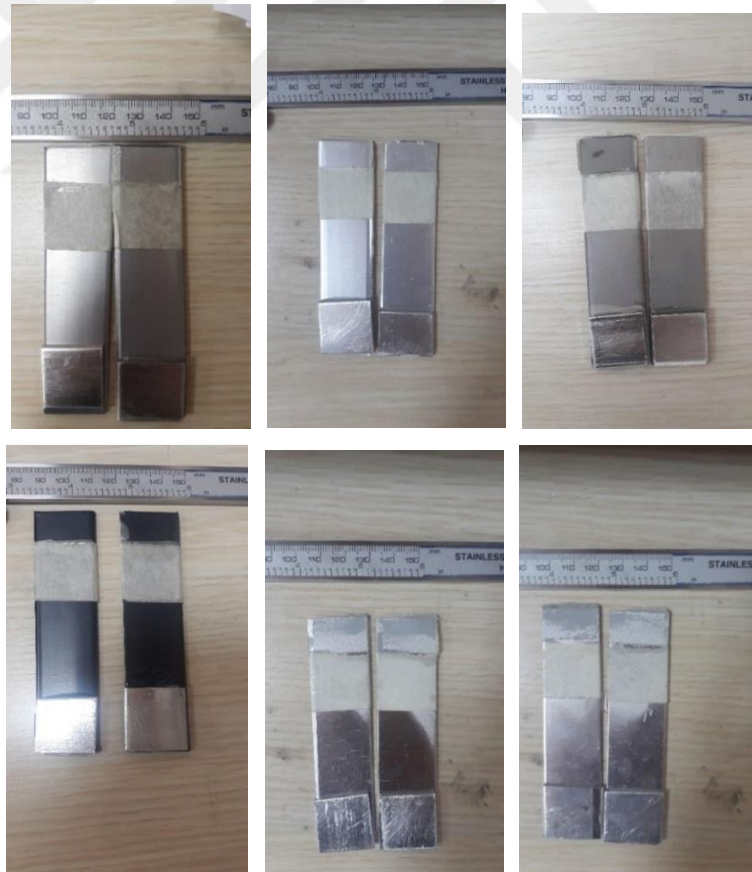
Şekil 5.44: Kaplanmış yüzeylerin çekme testi sonrasındaki görüntüleri a. 5-8 mikron eloksal b. 20-25 mikron eloksal c. 10-15 mikron eloksal d. 35-40 mikron sert eloksal e. 35-40 mikron sert eloksal +PTFE e. 40-50 mikron sert eloksal.
