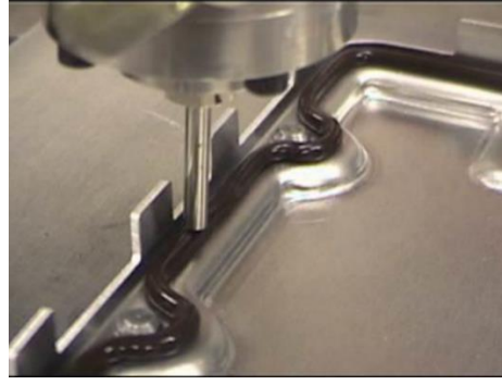
Şekil 4.12: Alüminyum bir kapak üzerine robotik olarak dağıtılan sıvı conta sızdırmazlık yapıştırıcısı [25].
