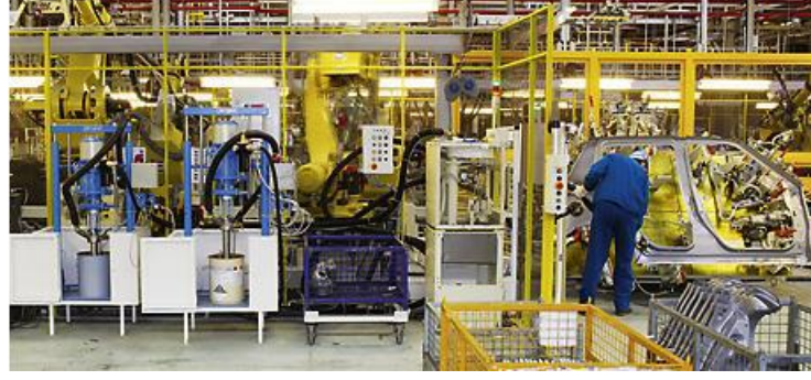
Şekil 4.8: Düşük ila yüksek viskoziteli yapıştırıcılar için ekstrüzyon pompaları [25].
