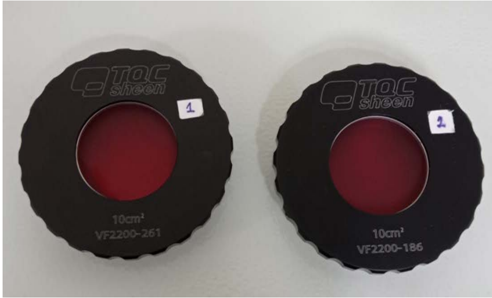
Şekil 3.4. Su buharı geçirgenlik analizinde kullanılan kaplara yerleştirilen % 5 Hbs özütü içeren nişasta filmler
