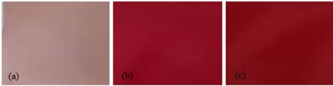
Şekil.4.2. (a) % 1, (b) % 3 ve (c) % 5 oranında Hbs özütü içeren kurutulmuş nişasta filmlere ait kesitler
