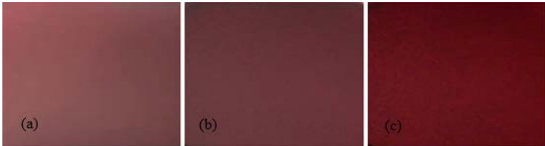
Şekil 4.3. (a) % 0.5, (b) % 1 ve (c) % 1.5 oranında GO içeren kurutulmuş nişasta filmlere ait kesitler
