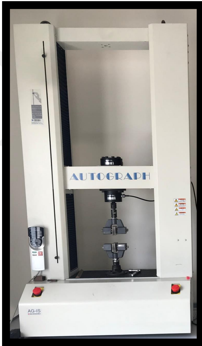
Şekil 3. 11. AUTOGRAPH AG-IS SHIMADZU markalı Gerilme Dayanımı Test Cihazı.
