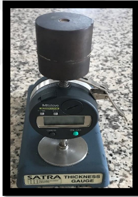
Şekil 3. 9. SATRA THICKNESS GAUGE marka mikrometre tipi kalınlık ölçüm cihazı.
