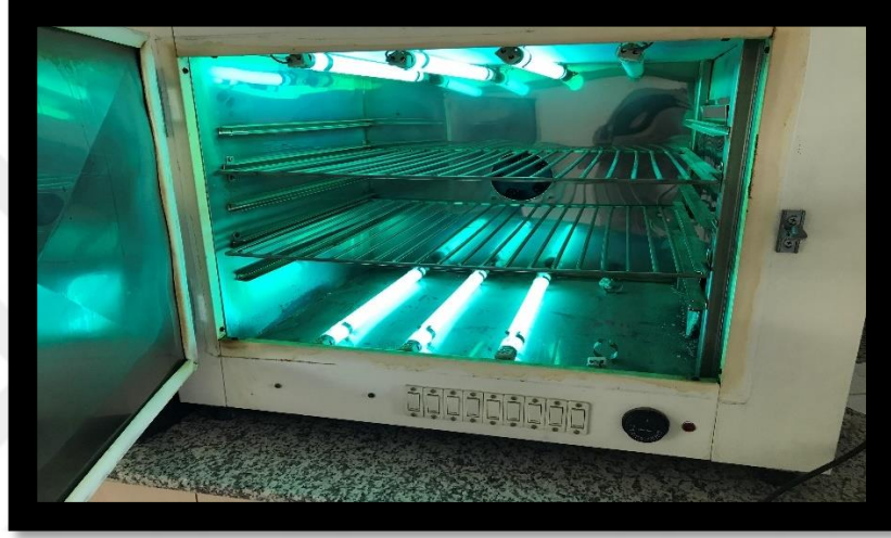
Şekil 3. 14. UV lambalar içeren ve sıcaklık ayarlı yaşlandırma cihazı.
