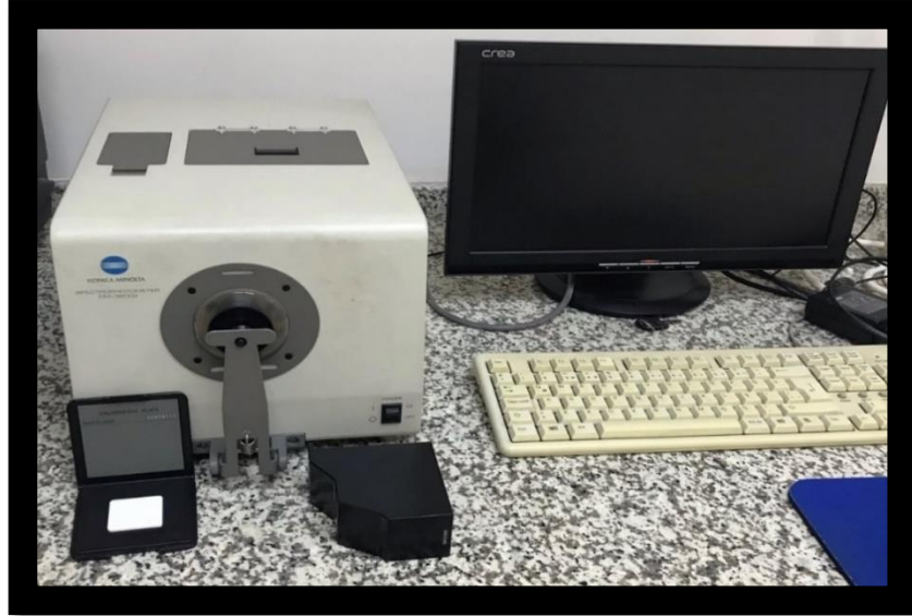
Şekil 3. 15. Derilerin renk ölçümlerinde kullanılan Konica Minolta Marka Spektrofotometre.
