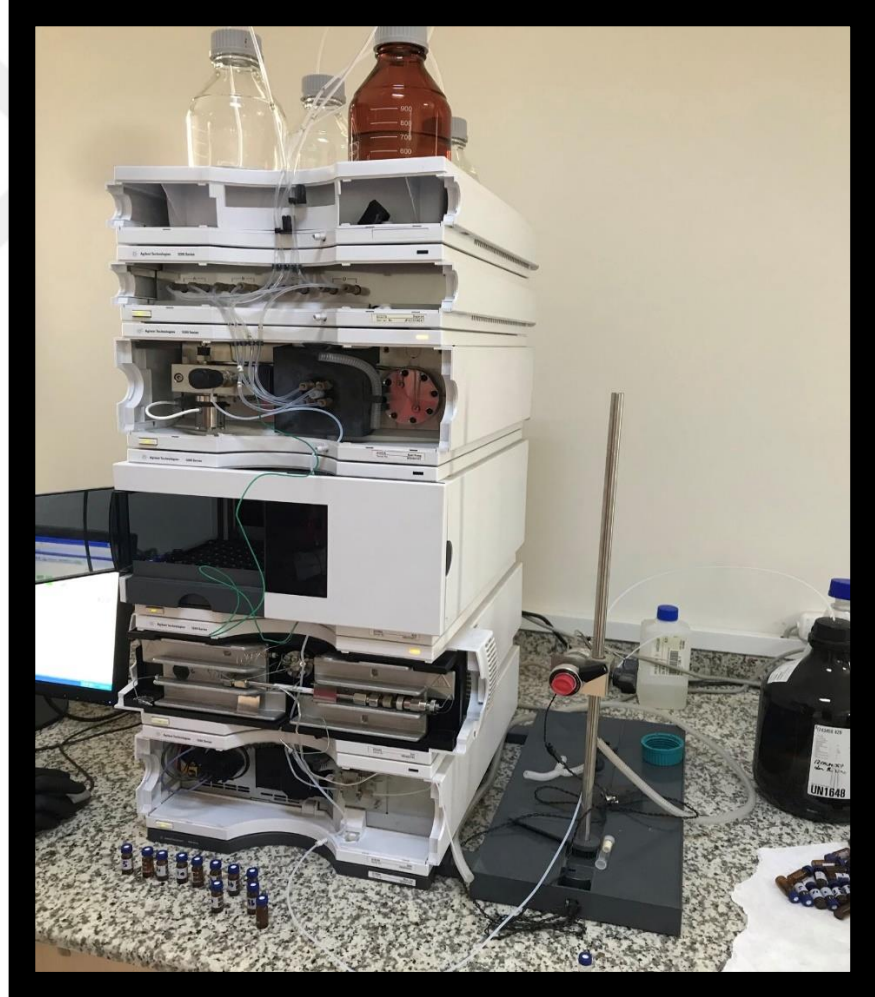
Şekil 3. 21. Agilent 1200 Series marka HPLC cihazı.
