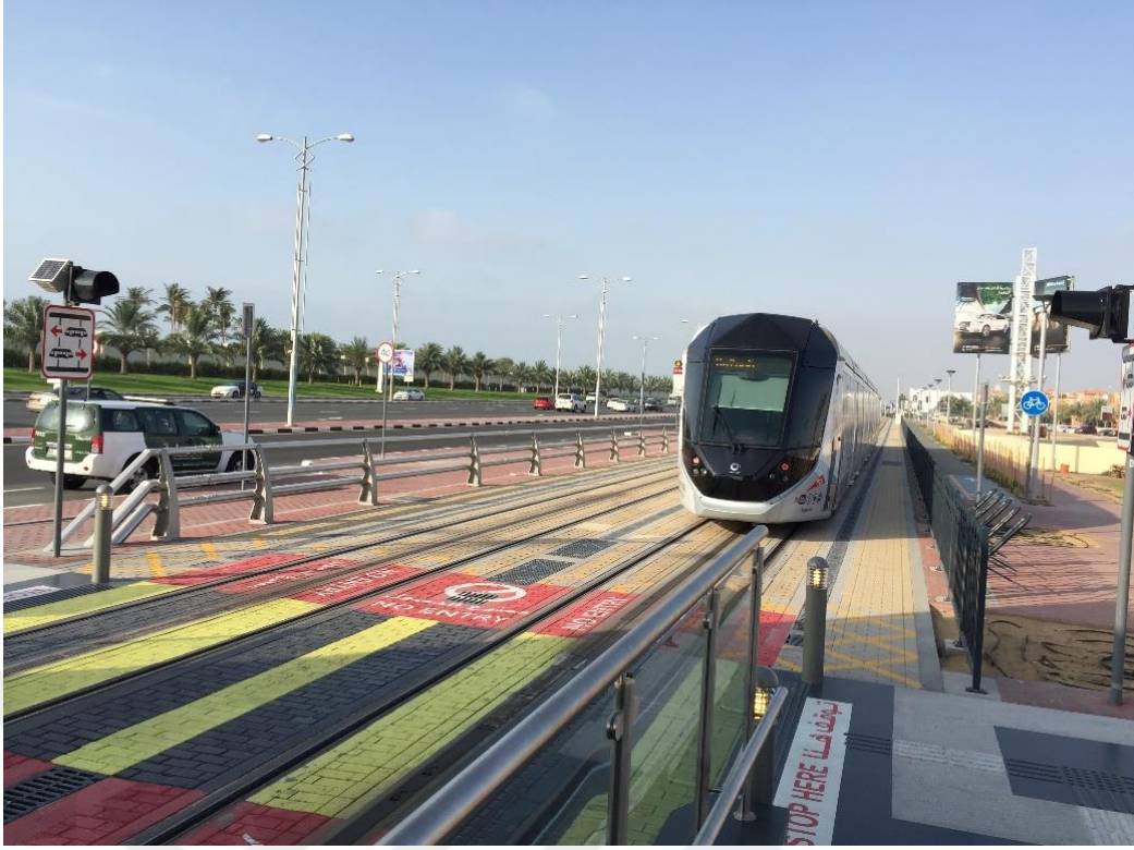
Şekil 2.2 Zeminden Sürekli Beslemeli Tramvay Aracı
