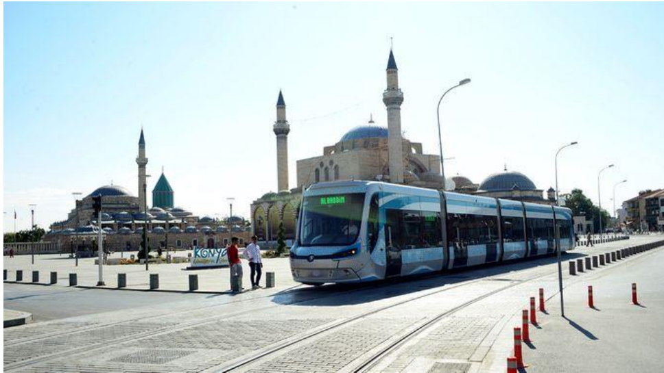
Şekil 3.25 Konya Tramvayı Katenersiz Sistem (Rayhaber, 2020)
