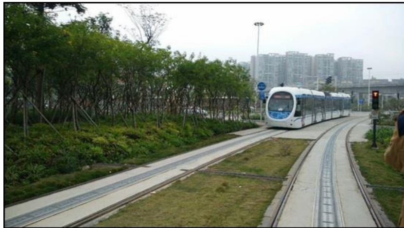
Şekil 2.14 Ansaldo Tramwave Yerden Besleme Sistemi (Ansaldo, 2020)
