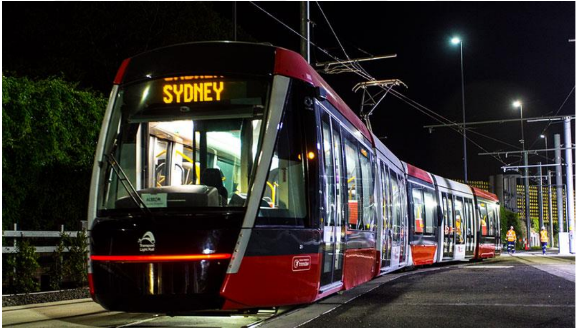
Şekil 3.23 Sidney Tramvayı Katenerli Sistem (Alstom, 2020)
