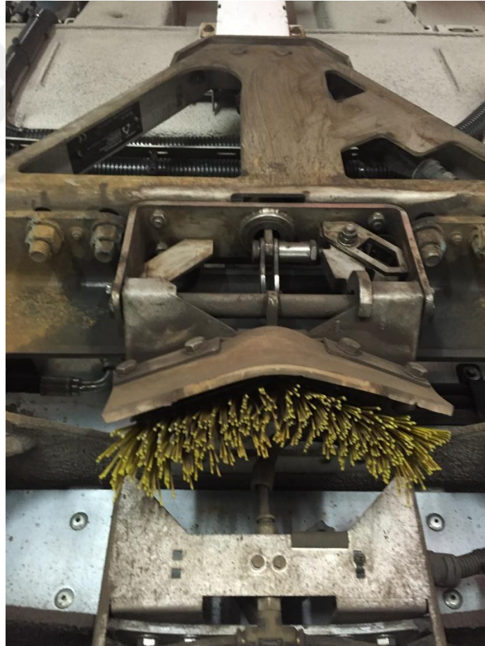
Şekil 3.4 APS Rayı Temizleme Fırçası (Metro İstanbul, 2020)
