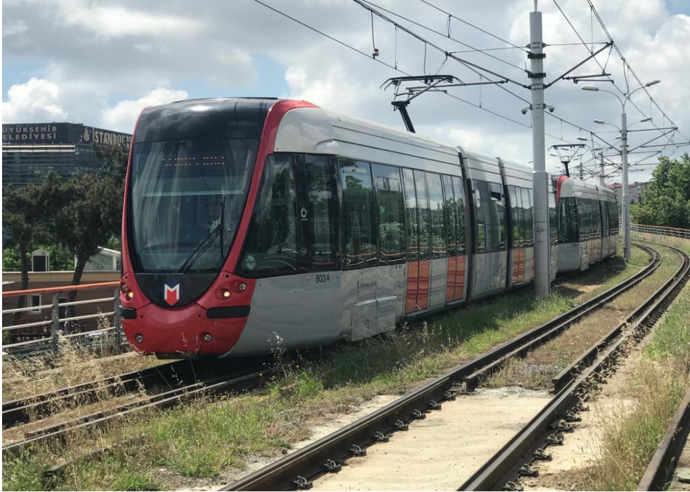
Şekil 2.3 Katener Beslemeli Tramvay Aracı
