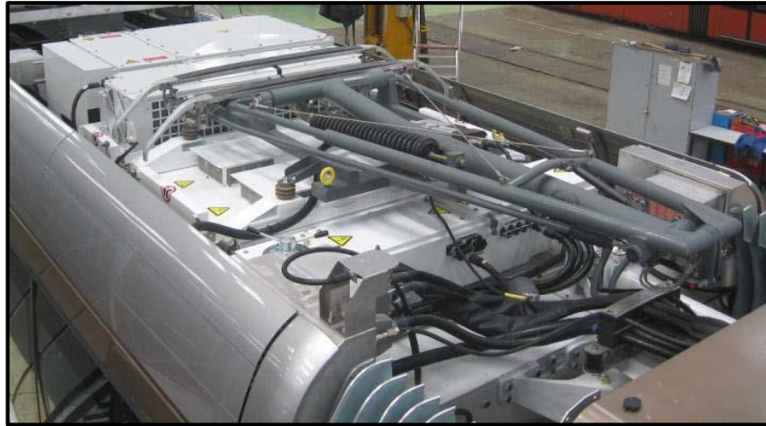
Şekil 2.34 Alstom Citadis Tramvayında NiMH Batarya Ünitesi (USTG, 2013)
