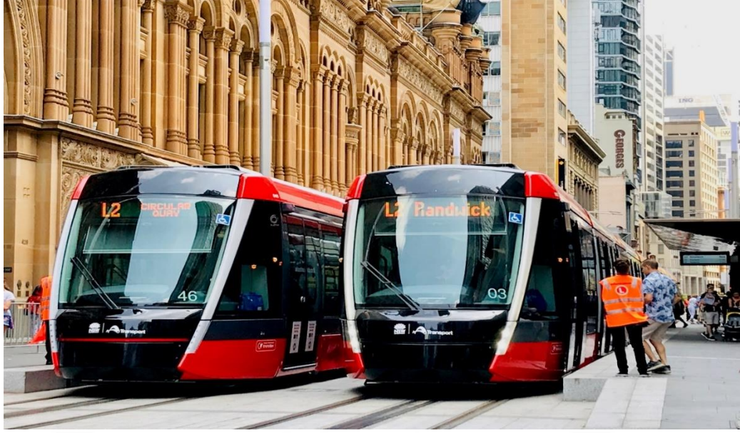
Şekil 3.22 Sidney Tramvayı Katenersiz (APS) Kısmı (Alstom, 2020)
