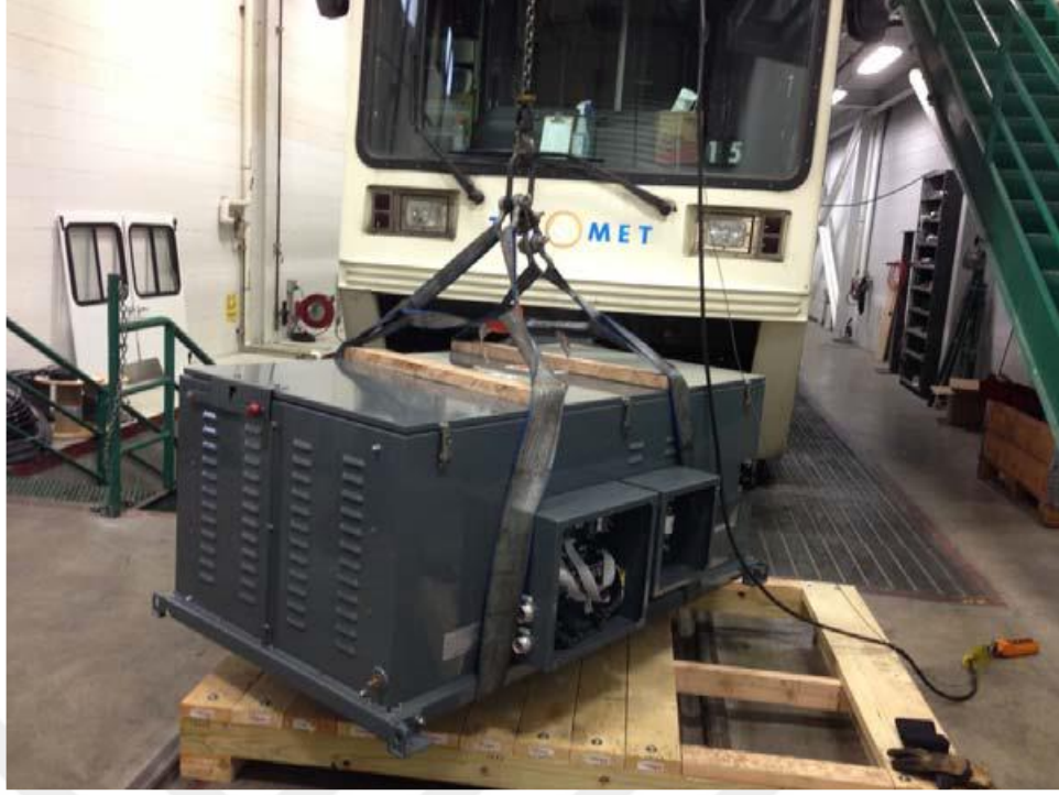
Şekil 2.36 Raylı Sistem Araçlarında Süper Kapasitör Depolama Ünitesi (USTG, 2013)
