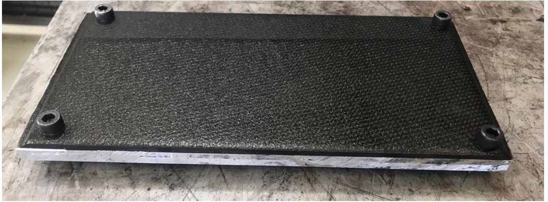
Şekil 4. 5: KFTP/Al 7075 İstif Yapıya Cıvata Uygulaması.
