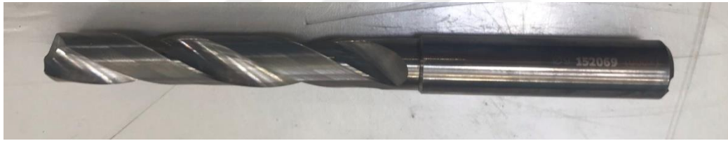
b) 9 mm apında kaplamasız karbür kesici takım
