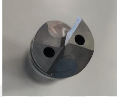
a) İten Soğutma kanalları
