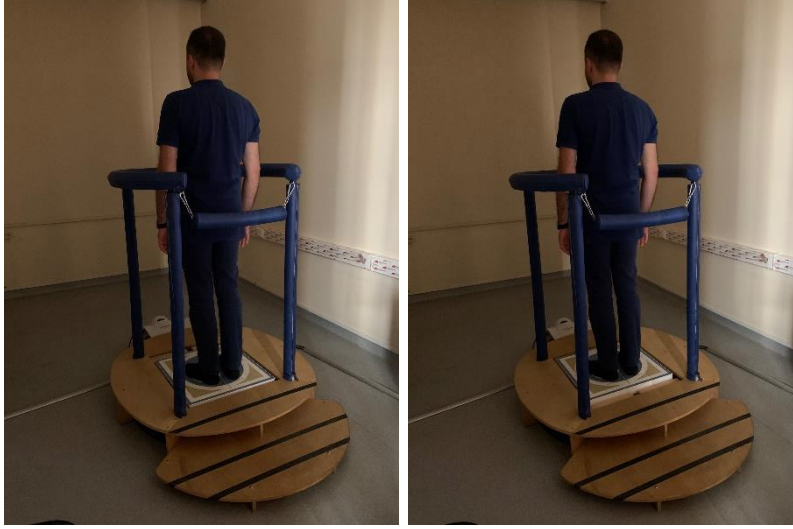
Resim 3.4. Synapsis postürografi sisteminde düşme değerlendirme; gözler kapalı, platform sinüzoidal hareketli
