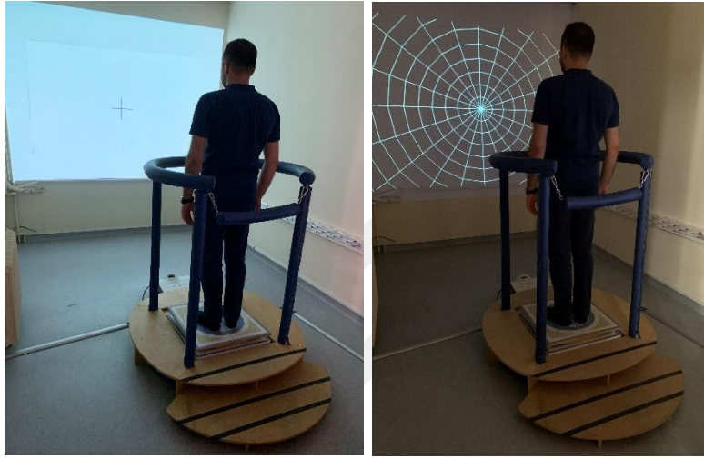
Resim 3.2. Synapsis postürografi sisteminde AP yönde SOT 4 ve ML yönde SOT 6
