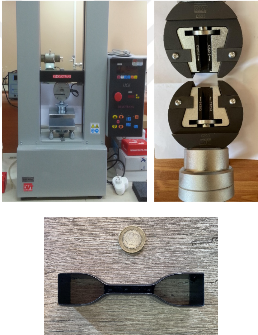
Şekil 3.16: Çekme-basma cihazı, çekme çeneleri ve çekme numunesi kalıbı
