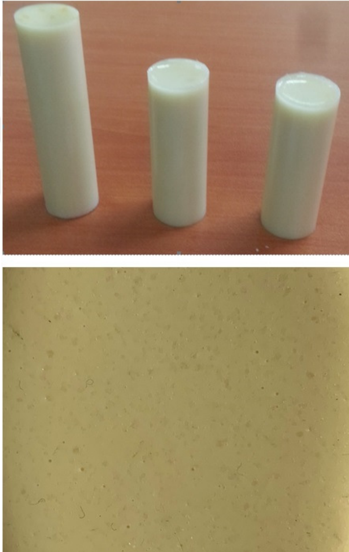
Şekil 3.12: PU-MMA/PMMA esaslı kendi-kendini iyileştiren numuneler
