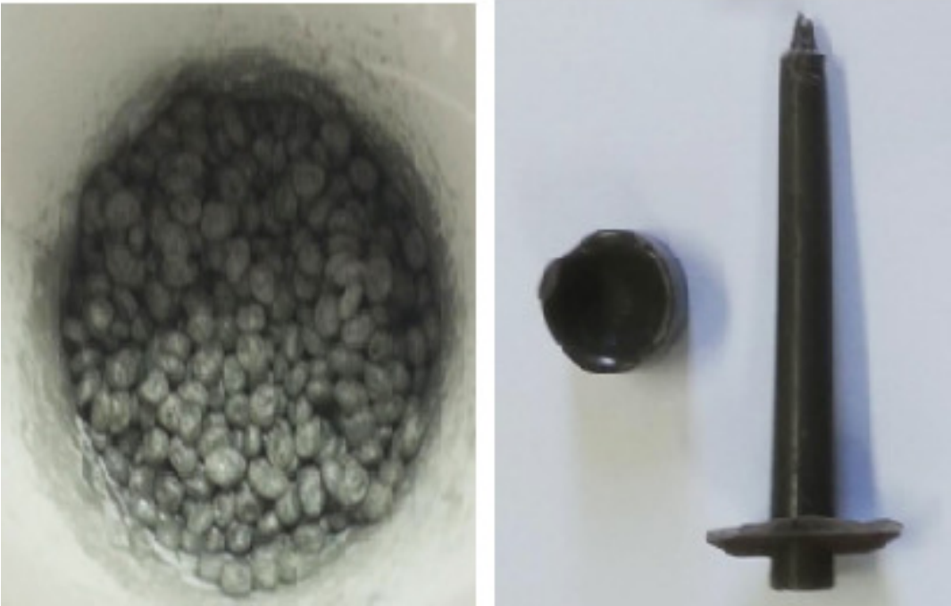
Şekil 3.2: Enjeksiyon yöntemi, a) PE, toz, kaplı granül, b) karışım, c) numune ve yolluk
