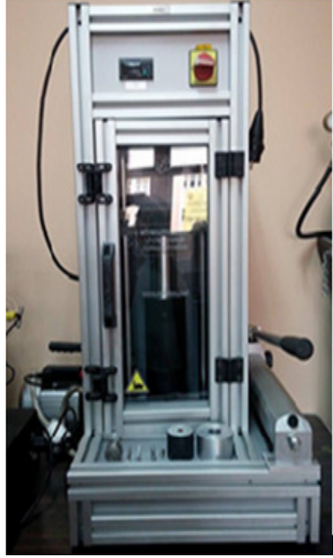
Şekil 3.7: Presleme-sinterleme yöntemi ile kompozit üretimi
