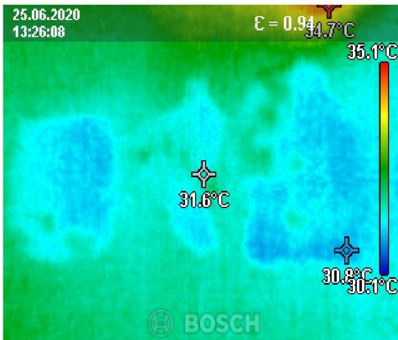
Şekil 4.20: PU kompozit numunelerin termal görüntüleme cihazı sonuçları
