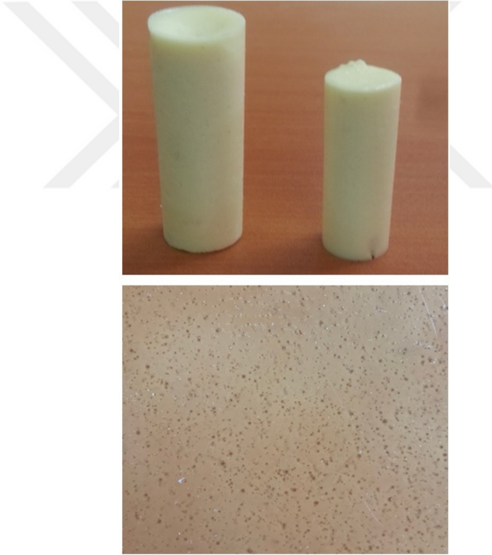
Şekil 3.15: PU-silikon esaslı kendi-kendini iyileştiren numuneler
