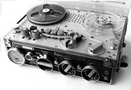
Resim 1.6. Nagra III NP Ses Kayıt Cihazı
