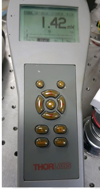
Şekil 4.23. 25 °C`de, Atmosfer basıncında, eşik akımında, harici geri beslemeli lazer ışık gücü.
