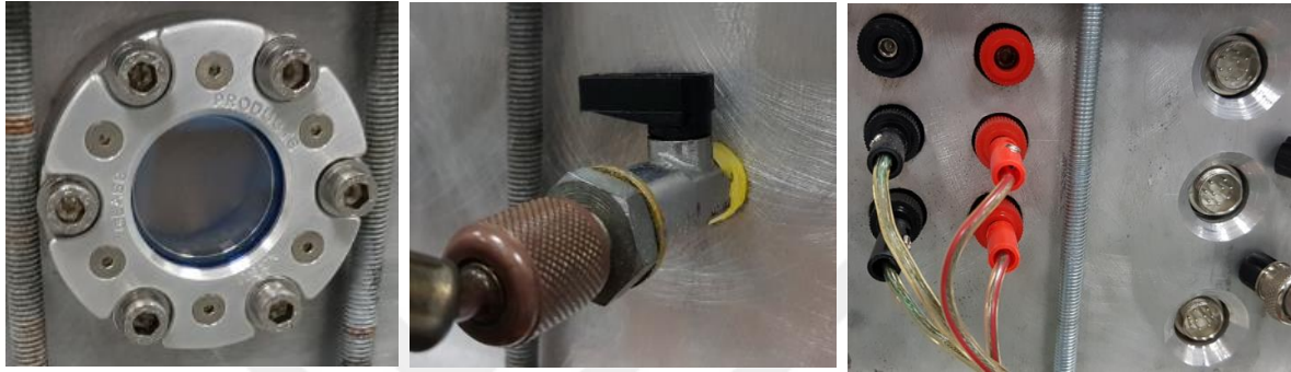
Şekil 3.2. Vakum penceresi bağlantısı, vakum pompası bağlantı vanası, elektrik ve veri bağlantı konnektörü.
