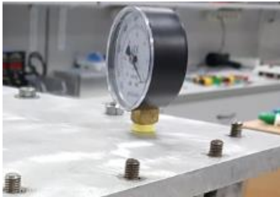
Şekil 3.22. Manometre ve vakum basınç vana montajı.
