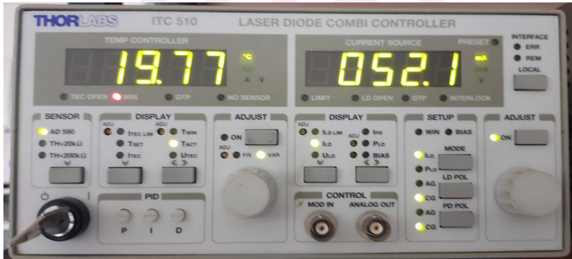
Şekil 3.33. Lazerleme için kombi kontrolör ayarları.
