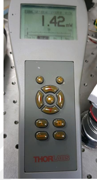
Şekil 4.15. Lazer çıkış gücü (1.42 mW)
