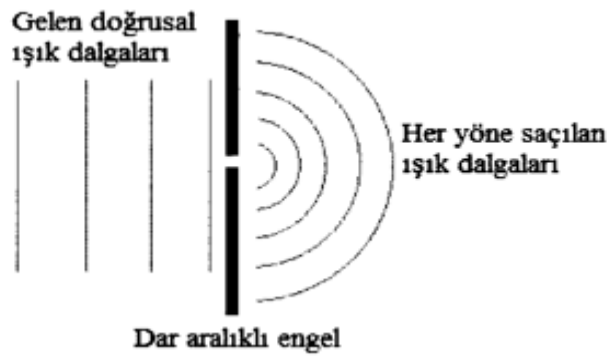
Şekil 2.4. Kırınım olayında dar aralıktan geçen dalga'nın her yöne saçılması [11].
