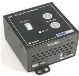
Şekil 3.11 DC servo motor sürücüsü (TDC 001 Thorlabs ). Durum ve hız kontrol Çift yönlü 4 hızlı hız kontrol. Trapezoidal hız profili
