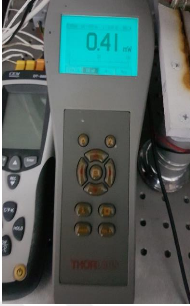
Şekil 4.22. 25 °C`de, Atmosfer basıncında, eşik akımında lazer ışık gücü.
