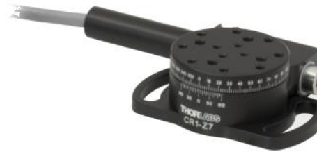
Şekil 3.12. DC Motor (Açısal hareket) (CR1Z7 Thorlabs). Çalışma Aralığı: 360° Sürekli dönüş Dişli Oranı: 256:1 Min. Artış: 2.19 arcsec Hız Aralığı: 6 deg/sec - 22 arcsec/sec
