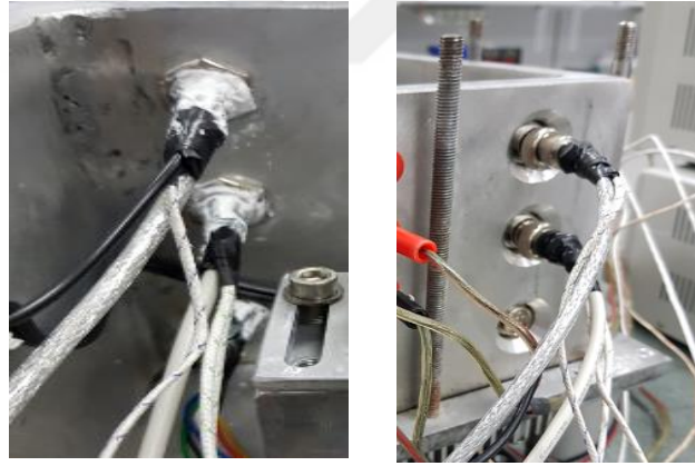
Şekil 3.6. Kabin içi ve dışı veri bağlantı soketleri.
