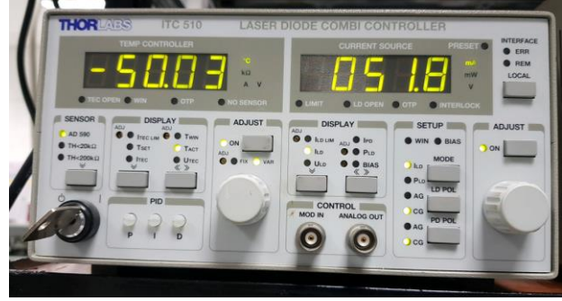
Şekil 4.21. Lazer kafa TEC güç beslemesi.
