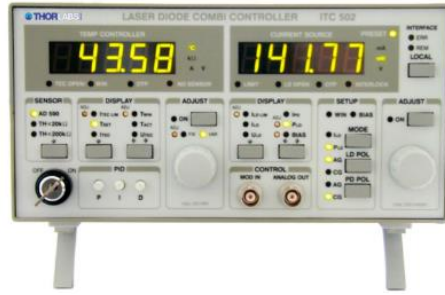
Şekil 3.9. Lazer diyot kombi kontrolör (ITC-510 Thorlabs).
