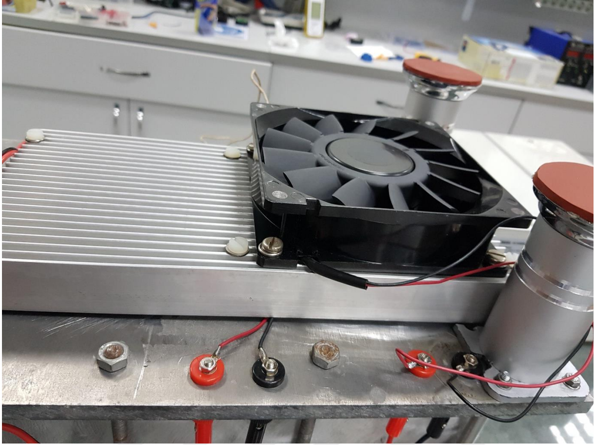
Şekil 3.17. Taban peltier, soğutucu petek, fan ve kablo bağlantıları.
