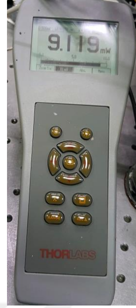
Şekil 4.24. -50.03 °C ~1 mbar basınç değerinde eşik akımında lazer ışık gücü.
