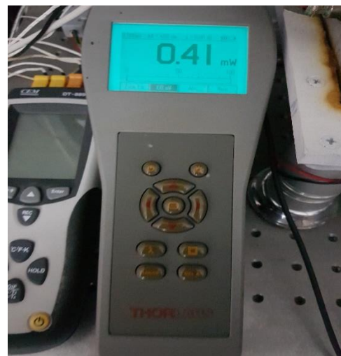
Şekil 4.13. Lazer çıkış gücü (0.41 mW)
