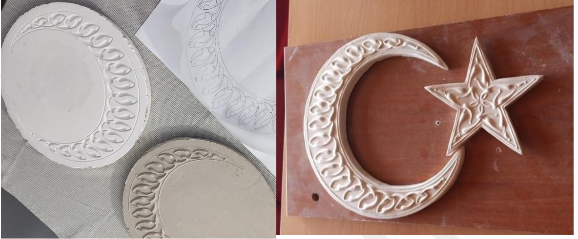
Alçı kalıp oluşturma, çamur basma, bisküvi pişirimi
