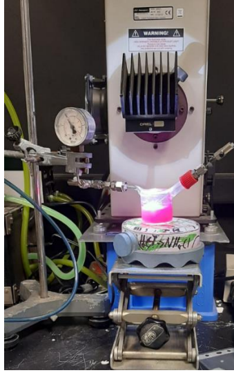
Görsel 2.1. Fotokatalitik su ayrışması reaksiyon düzeneği (sol), standart solar spektrum (sağ).
