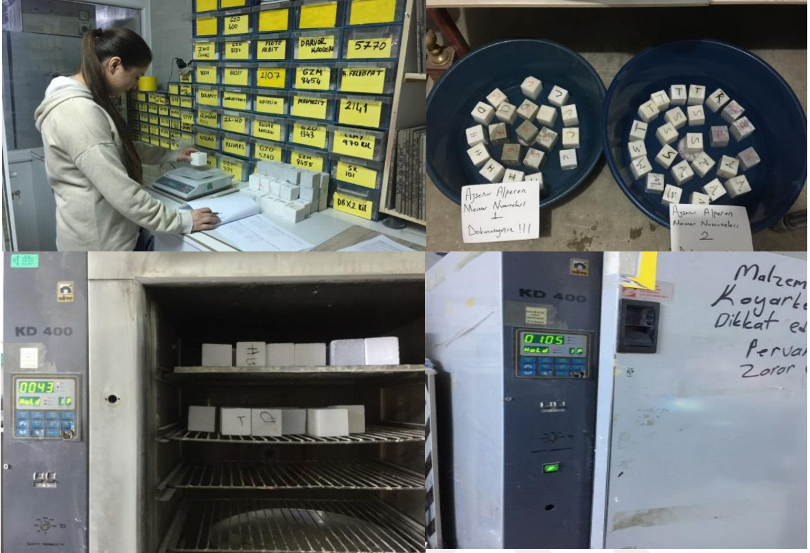
Resim 8.3 Birim hacim ağırlık deneyi ve etüve ait görüntüler
