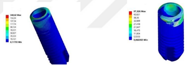
Şekil 4. 2. Maksimum interkusal pozisyonda implantlarda meydana gelen Von Mises stres değerleri
