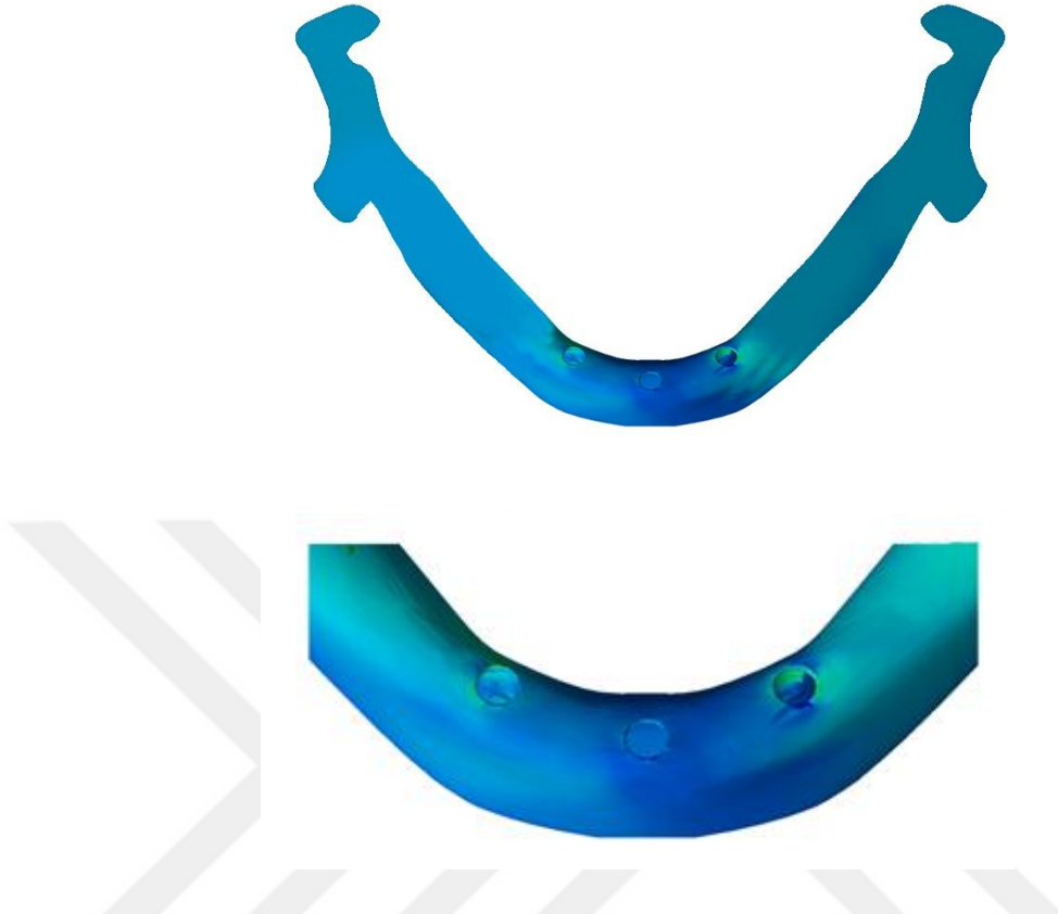
Şekil 4.11. Kanin koruyuculu oklüzyonda kortikal kemikte meydana gelen maksimum asal gerilme
