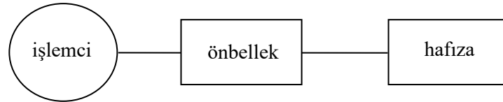
Şekil 3.20. Önbellek-tabanlı FFT mimarisi blok diyagramı
