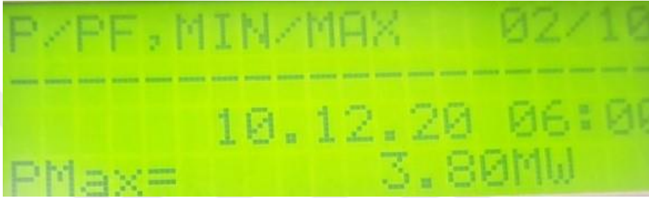
Şekil 4.6 : Maksimum anlık güç saha ölçümü.
