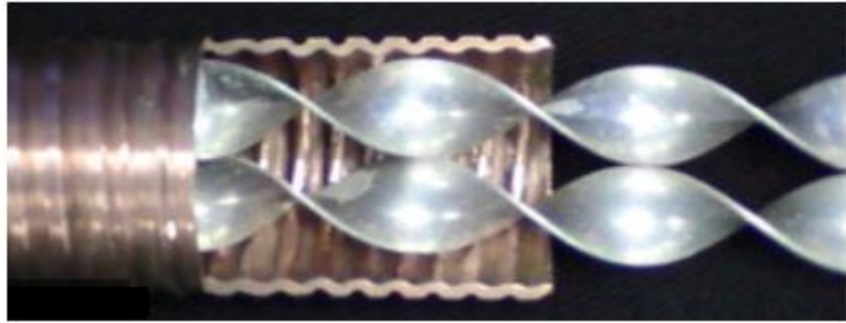
Şekil 2.13 Çiftli burulmuş şerit
