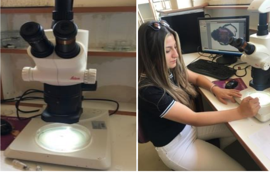
Şekil 3.7. Stereo binoküler mikroskop yardımıyla makro fotoğrafların çekimi.
