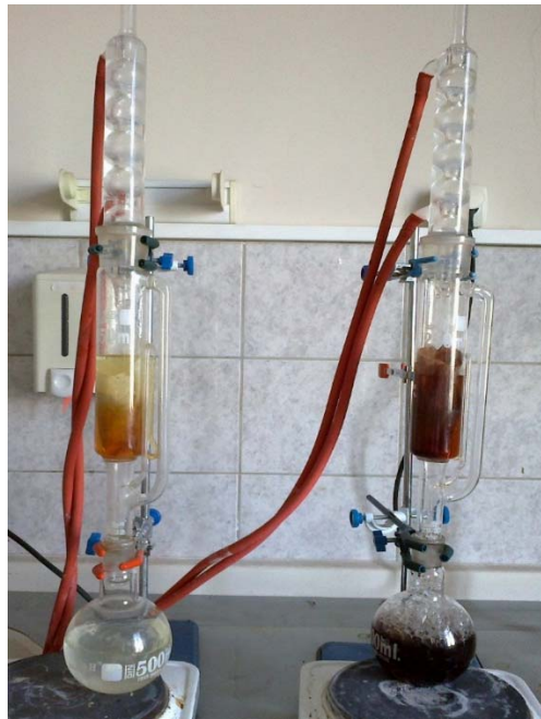
Şekil 2. 27. Bitkilerden boyarmadde ekstraktelerinin elde edildiği ekstraksiyon düzeneği
