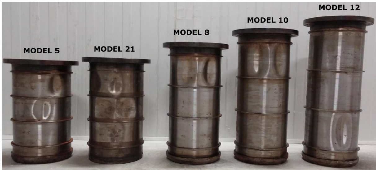
Şekil 3.12 : Deney sonrası burkulmuş modeller.
