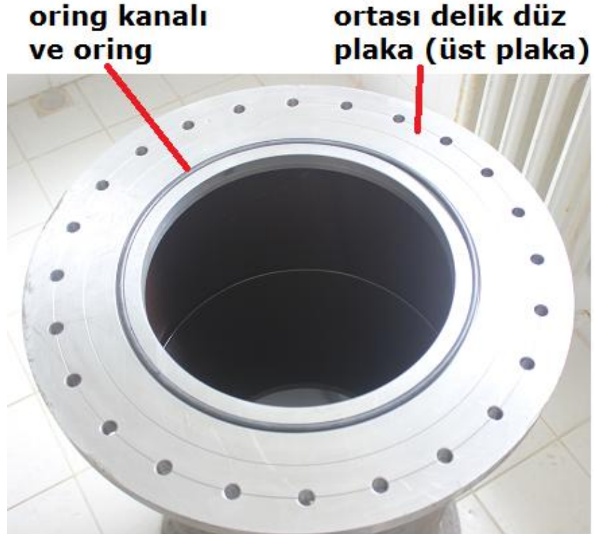
Şekil 3.7 : Deney düzeneği ve bileşenleri (2).
