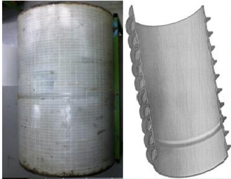
Şekil 2.4 : Simetrik burkulma modunu gösteren görseller.
