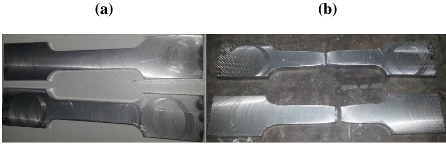
Şekil 3.11 : Çekme testi numuneleri (a) St-42 malzeme (b) St-44 malzeme.
