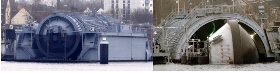
Şekil 3.4 : Basınçlı denizaltı yüzer havuzu.
