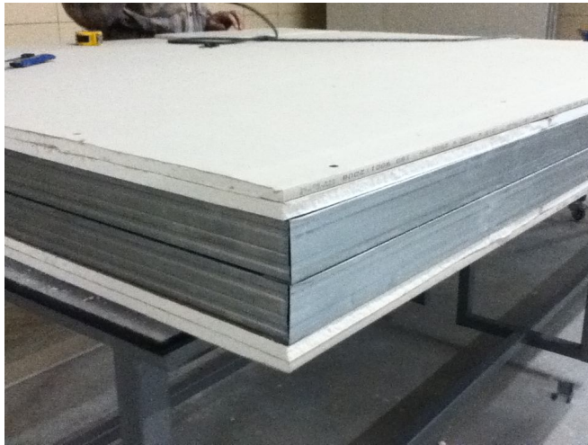
Şekil 5.6. 2 adet 50 mm'lik profil ve çift alçıpan
