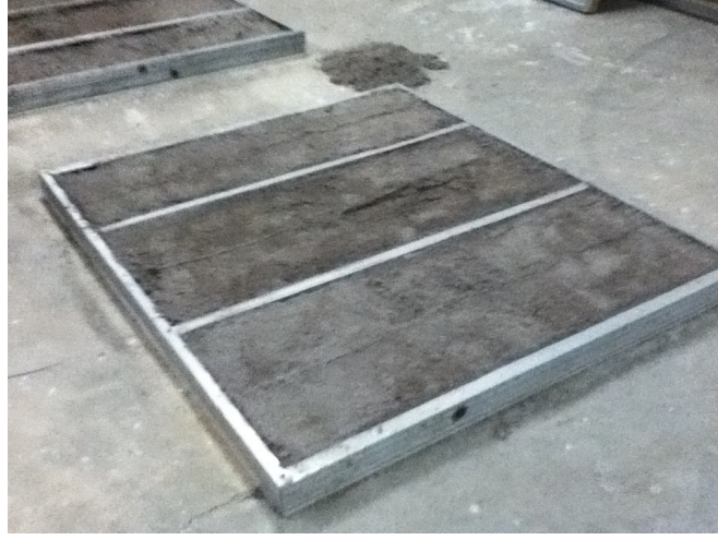
Şekil 5.10. celluBor'la tam doldurulmuş deney numunesi
