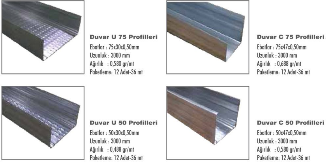
Şekil 5.13. C ve U profillerinin özellikleri
