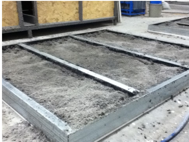
Şekil 5.9. celluBor'la yarım doldurulmuş deney numunesi
