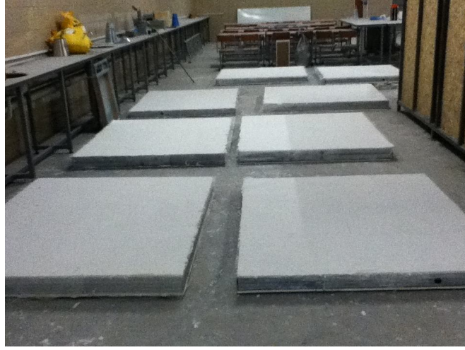
Şekil 5.11. Alçı çekilmiş deney numuneleri
