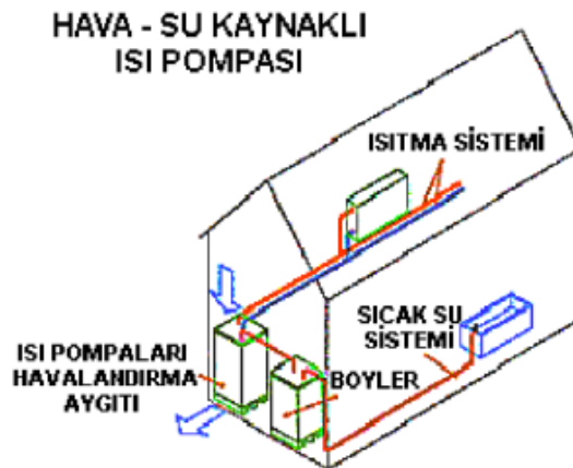
Şekil 3.4. Hava-Su kaynaklı ısı pompası (Yamankaradeniz, 2007).
