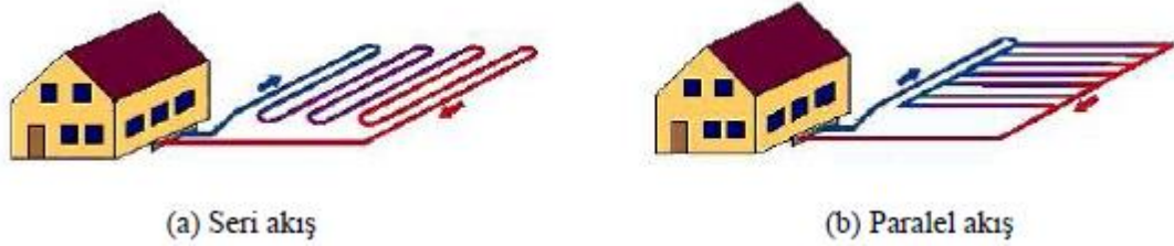
Şekil 3.8. Isı taşıyıcı akışkanın akış şekline göre toprak ısı değiştiricileri (Tokgöz, 2006).
