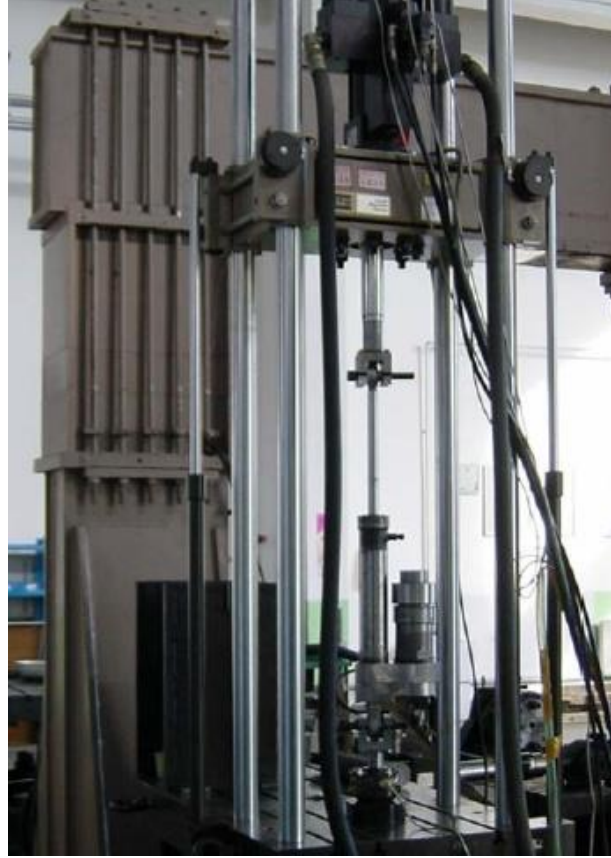
Şekil 2.9. Test teçhizatı ve hidropnömatik yay (Shi ve ark., 2009)
