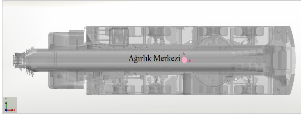
Şekil 5.6. Aracın ağırlık merkezinin üstten görünümü
