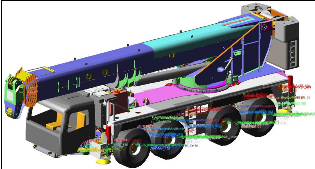
Şekil 5.7. MSC ADAMS/View ortamında kurulan model
