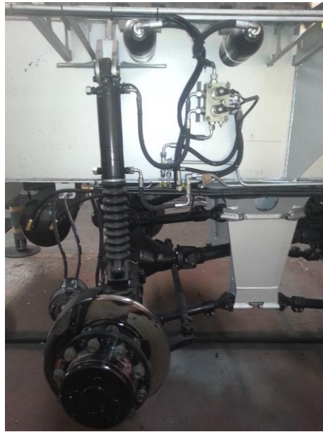
Şekil 1.7. Prototip aracın süspansiyon sistemi
