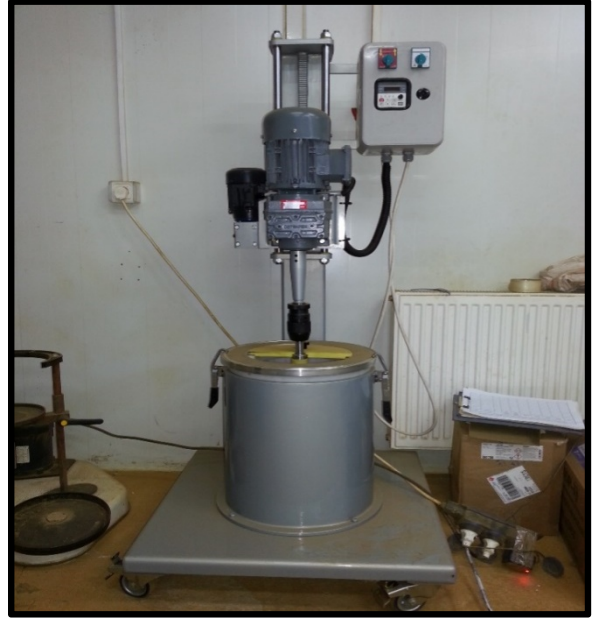
Fotoğraf 6.1 Öğütme işleminin yapıldığı dik karıştırmalı bilyeli değirmen
