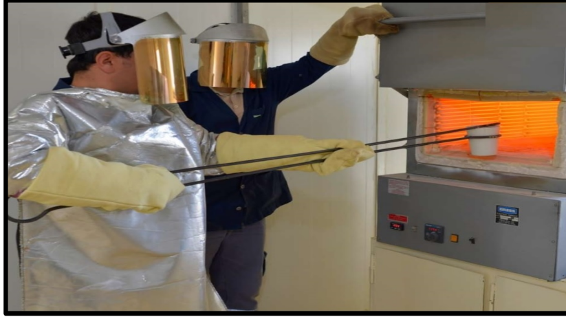
Fotoğraf 6.4 Döküm potası vasıtasıyla ergitme işlemi
