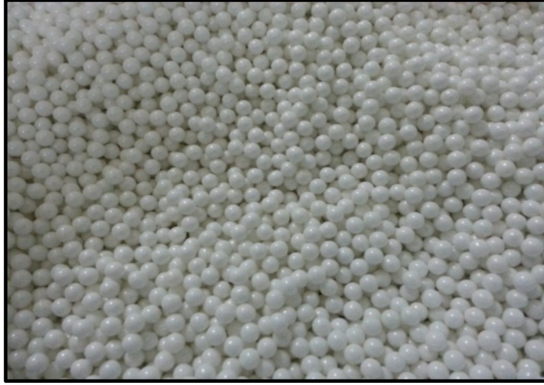
Fotoğraf 6.2 Dik karıştırılmalı bilyeli değirmende kullanılan zirkonyum bilyeler
