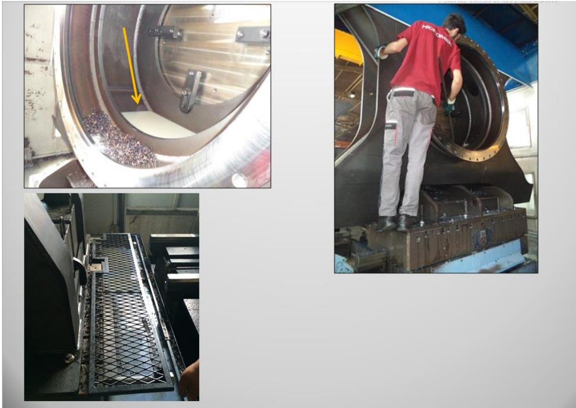
Resim 3.1. Ekskavatör alt şase orta merkezin talaşlı imalatı esnasında, oluşan talaş ve yağın içeriye girmemesi için mıknatıslı manyetik kapak biçiminde aparat yapımı ve parçanın içine dolan yağın temizlenmesi için de basamak ilavesi
