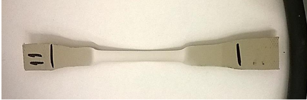
Şekil 4-6: Polimer numunenin çekme testi sonrası görüntüsü.
