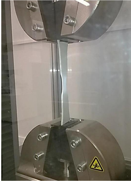
Şekil 4-5: Polimer numunenin çekme testi esnasındaki görüntüsü.
