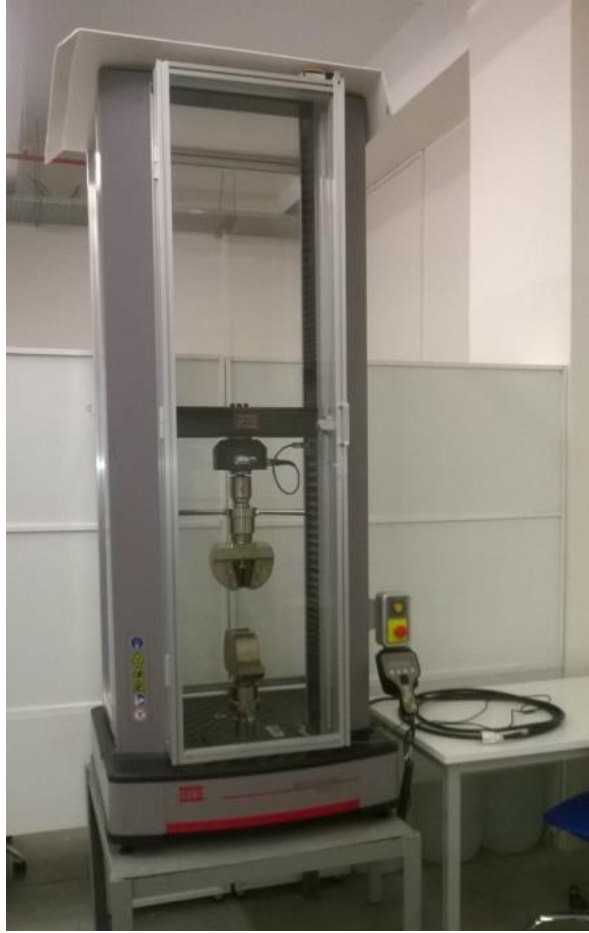
Şekil 4-4: MTS Criterion 5 ton çekme test cihazı.
