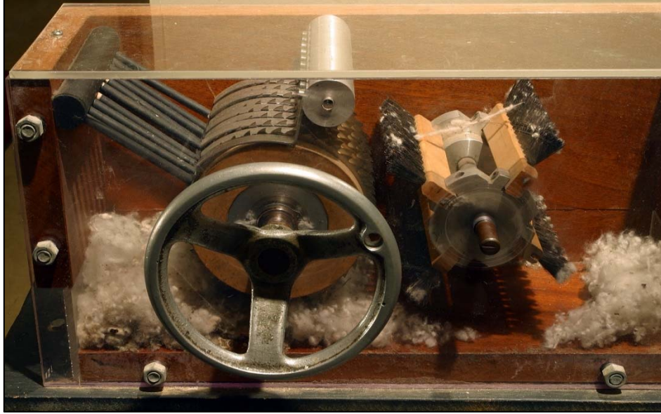
Şekil 1.11. Hodgen Holmes tarafından geliştirilen sawgin makinesi modeli (Baker ve Griffin, 1994)
