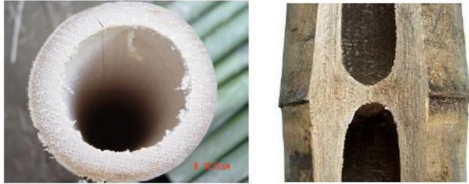
Şekil 1.18. Bambu bitkisinin enine kesiti (a) , boyuna kesiti (b) [20]
