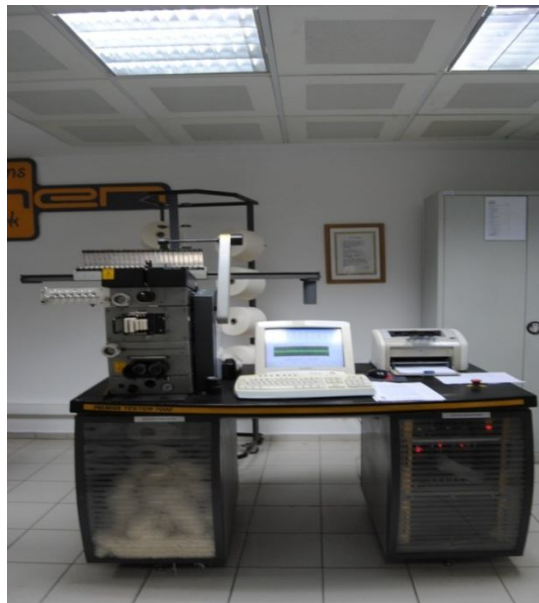
Şekil 2.12. Çalışmada kullanılan Premier PT 7000 cihazı
