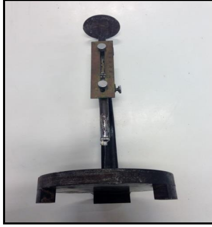
Resim 8 Vicat cihazı ve Vicat halkası
