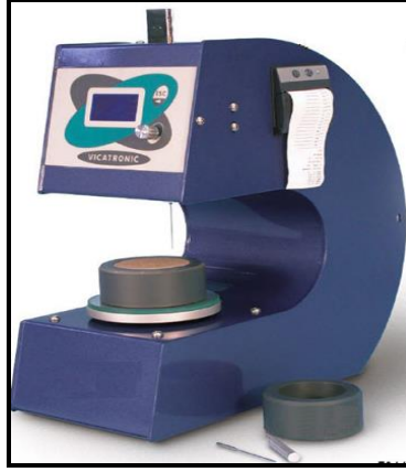
Şekil 8 Otomatik Vicat iğnesi ( http://www.worldoftest.com/vicatronic.htm , Erişim tarihi:20.08.2014)
