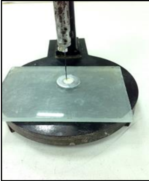
Resim 9 Sertleşme süresinin belirlenmesi
