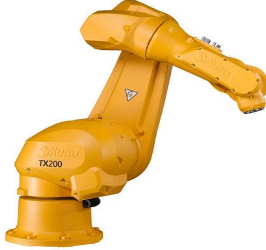
Şekil 2.3 : Staubli TX200 altı serbestlik dereceli modeli.
