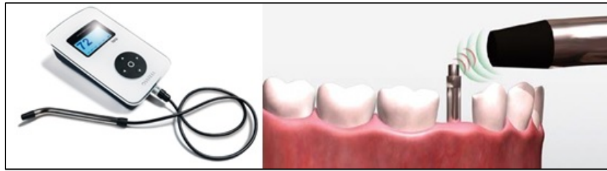
Şekil 1.1. Osstell Mentor cihazı ve ISQ ölçümü
