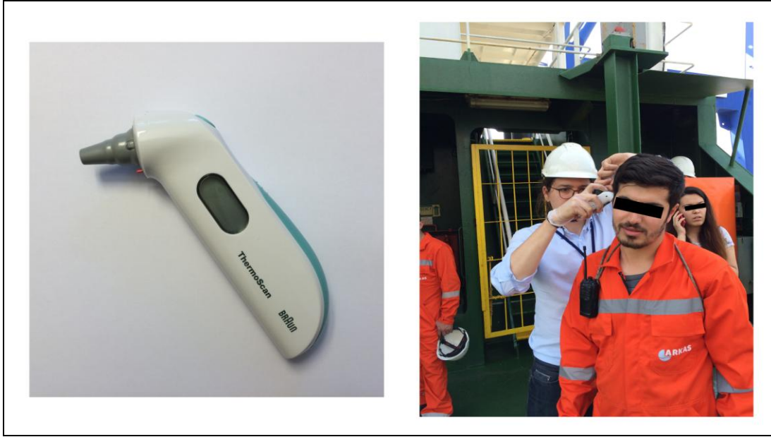
Şekil 3.5 : Kulaktan ateş ölçer ve kullanım şekli.
