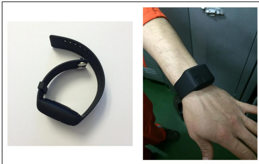
Şekil 3.3 : E4 wristband ve kullanım şekli.
