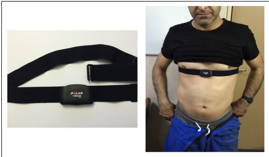
Şekil 3.4 : H7 polar band ve kullanım şekli.
