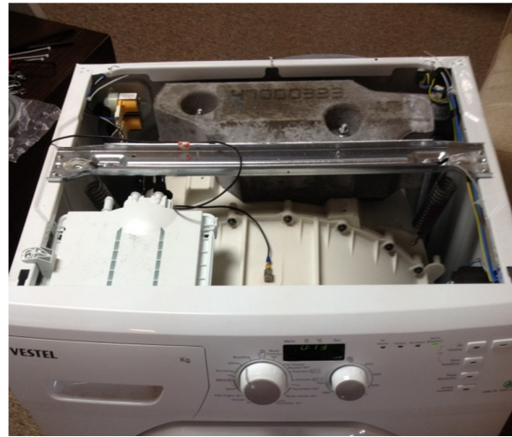
Şekil 4.2 : İvme ölçerin kazan üzerindeki konumu.
