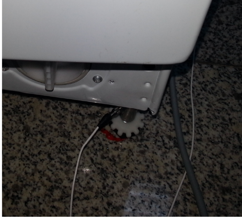
Şekil 4.3 : Kuvvet Ölçerin 1. ayak üzerindeki konumu.
