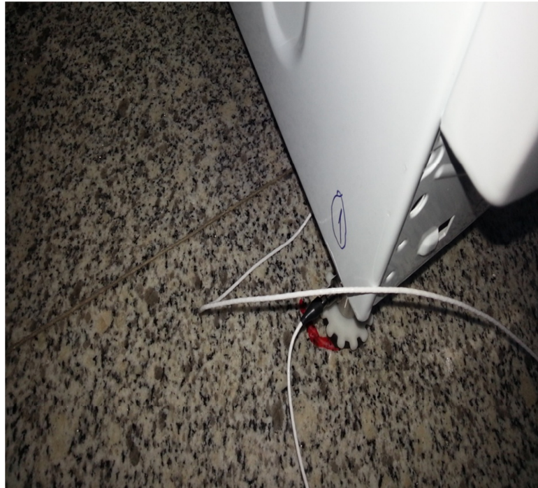
Şekil 4.4 : Kuvvet ölçerin 2. ayak üzerindeki konumu.
