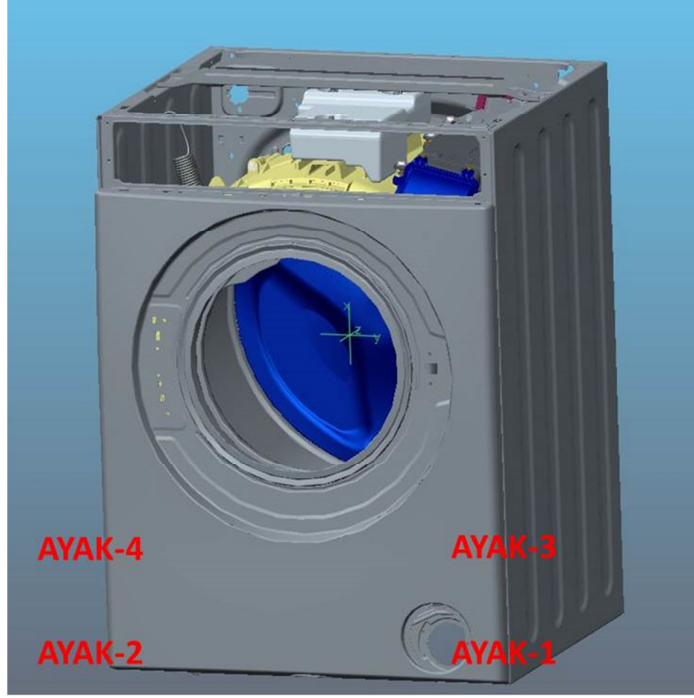
Şekil 4.1 : Çamaşır makinesi ayaklarının numaralandırılması.
