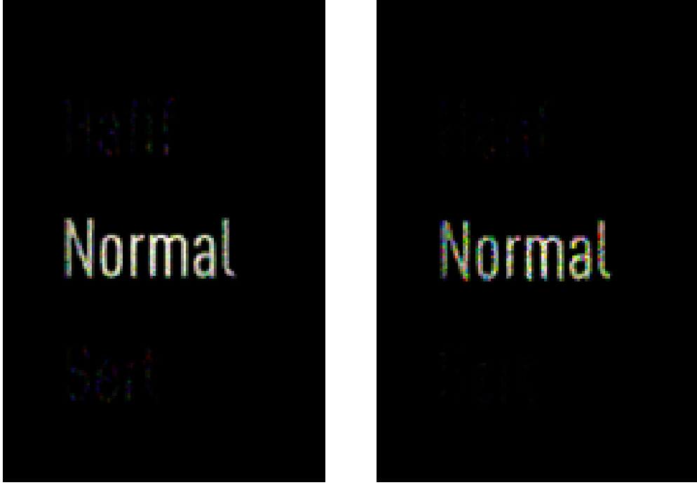
Şekil 4.8 : İzin verilen ışık kaçađı karşılaştırması; tasarım 1 (sol) tasarım 2 (sađ).
