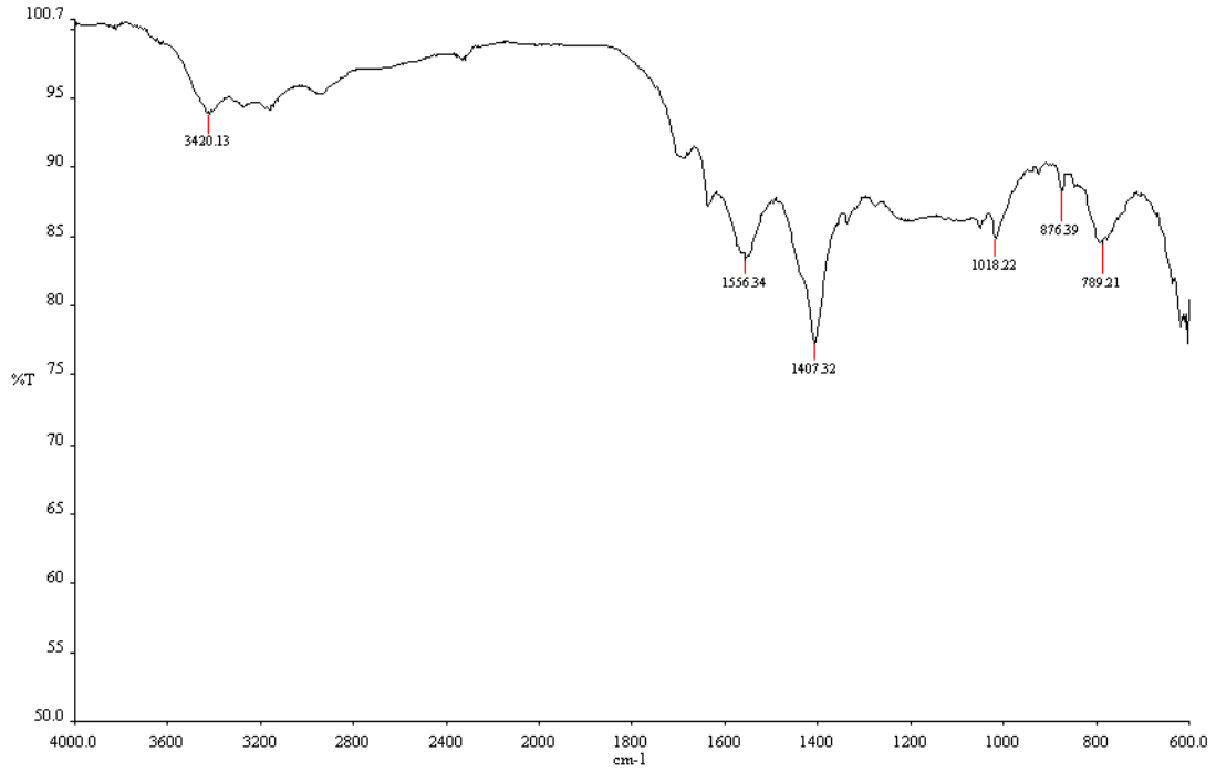
Şekil 4.10 300 °C'de asma budaklarından elde edilen biyokömürün FT-IR spektrumları
