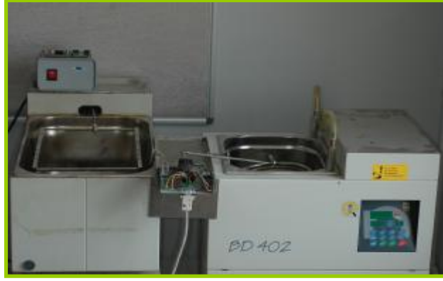
Şekil3.6. Termal siklüs işleminin yapıldığı ‘ Termosiklus’ cihazı.
