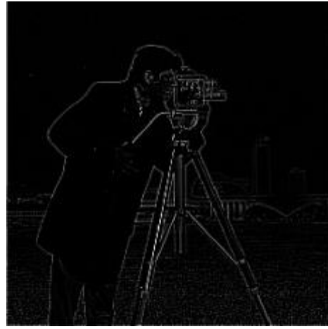
(b) Orijinal görüntüye yüksek geçiren filtre uygulanması sonucundaki görüntü
