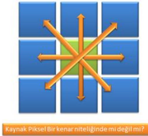
Şekil 4.11. Gidilen kaynağın kenar piksel olup olmamasının komşularının gri seviye değerlerine bakılarak karar verilmesi aşaması
