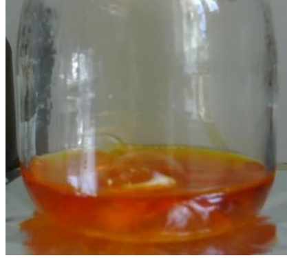
Şekil 5.2 : Platin çözündürme işlemi sonunda elde edilen çözelti.
