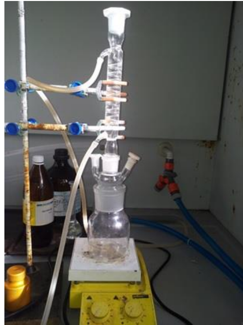
Şekil 4.2 : Çözme deneylerinin gerçekleştirildiği deney düzeneği.
