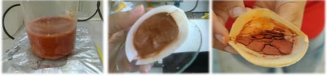
Şekil 5.16 : Çöktürme yapılan çözeltiye, filtrasyon ve kurutma sonrasına ait görsel.
