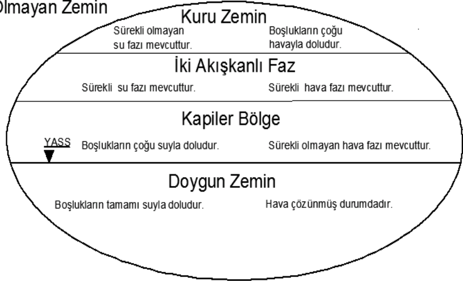
Şekil 2.2 : Doymun zemin ve doymamış zemini ayıran bölgeler [5].
